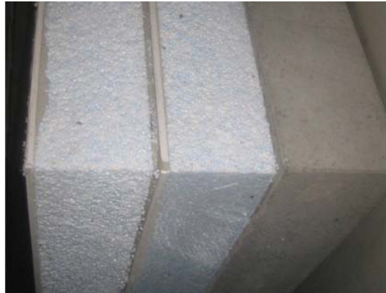
Abb. 22: Zweilagiges Wärmedämm-Verbundsystem mit 2 x 100 mm Dämmstoffdicke auf einer Stahlbetonplatte (Seitenansicht). Zur Herstellung dieses Aufbaus wurde auf die Betonplatte zunächst ein WDVS mit einer Dicke von 100 mm geklebt. Auf diesem WDVS wurde dann auf gleiche Weise ein zweites System befestigt.
