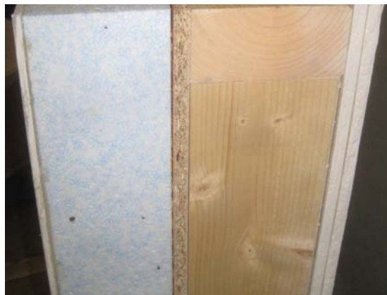
Abb. 23: Wärmedämm-Verbundsystem mit 100 mm Dämmstoffdicke auf der Holzständerwand. Im Unterschied zu den Massivwänden wurde die Dämmplatte in praxisüblicher Weise vollflächig mit der Außenschale der Wand (Spanplatte) verklebt. Die Auftragung des hierzu verwendeten Dispersionskleber erfolgte mit der Zahntraufel. Die Dicke der Klebeschicht betrug ca. 4 mm.
