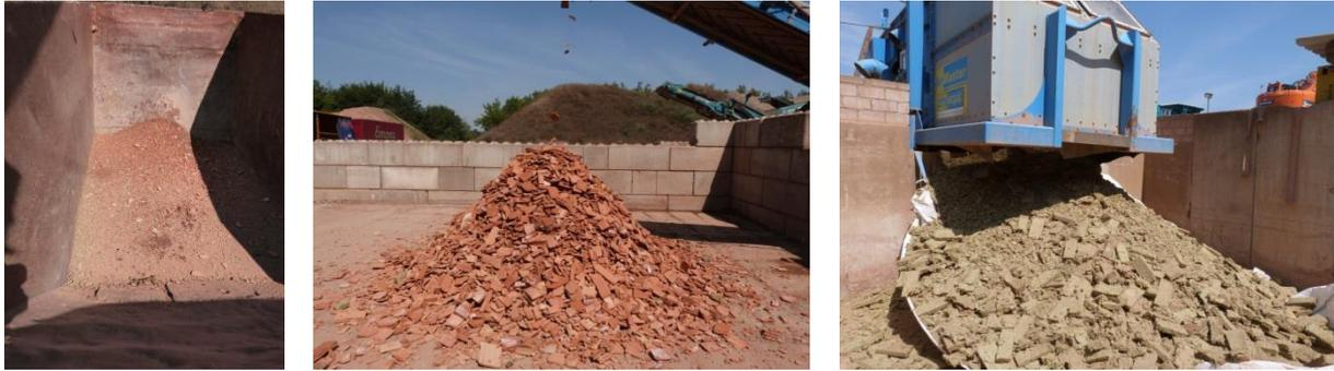
Bild 33: Feinfraktion nach Vorabsiebung (links) sowie nach der Windsichtung sortenrein zurückgewonnene Ziegelscherben (Schwerfraktion, mittig) und Steinwolle-Pads (Leichtgut, rechts)
