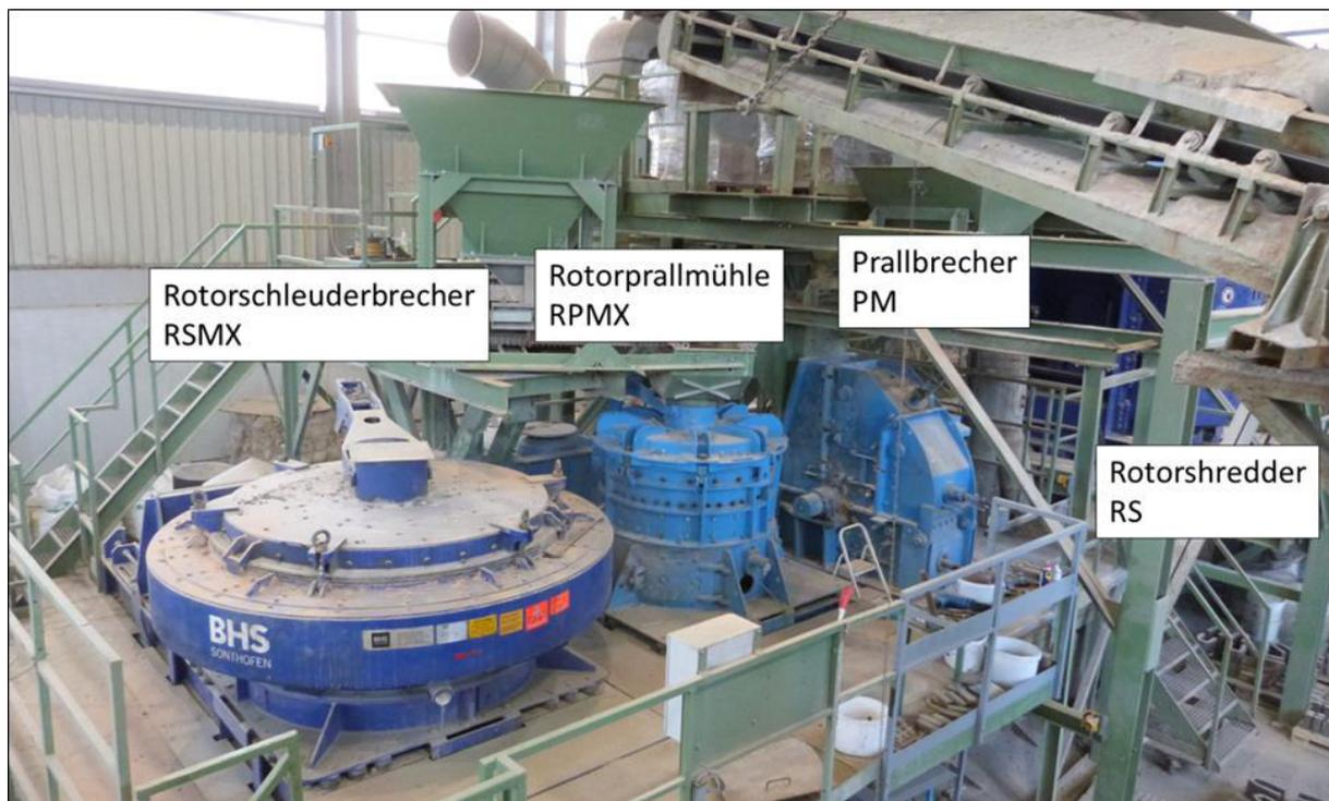
Bild 5: Aufbereitungstechnikum der Fa. BHS mit Zerkleinerungsmaschinen
