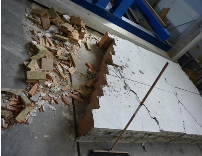
Bild 3: Rückbau der Wände
