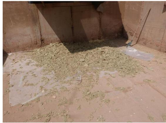
Bild 28: Materialausträge während der Windsichterversuche: Siebfraction < 10 mm (links), Steinwolle als Leichtgut (rechts)
