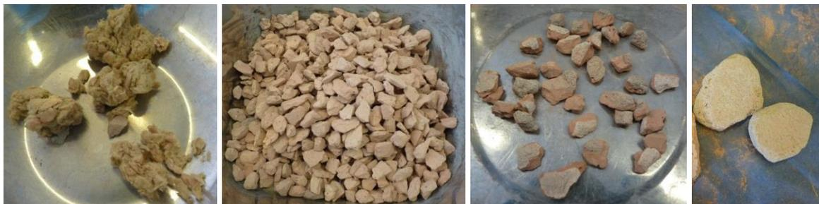
Bild 21: Sortiertes Material aus Steinwolle, Ziegel, Verbundpartikel, Putz (von links nach rechts)
