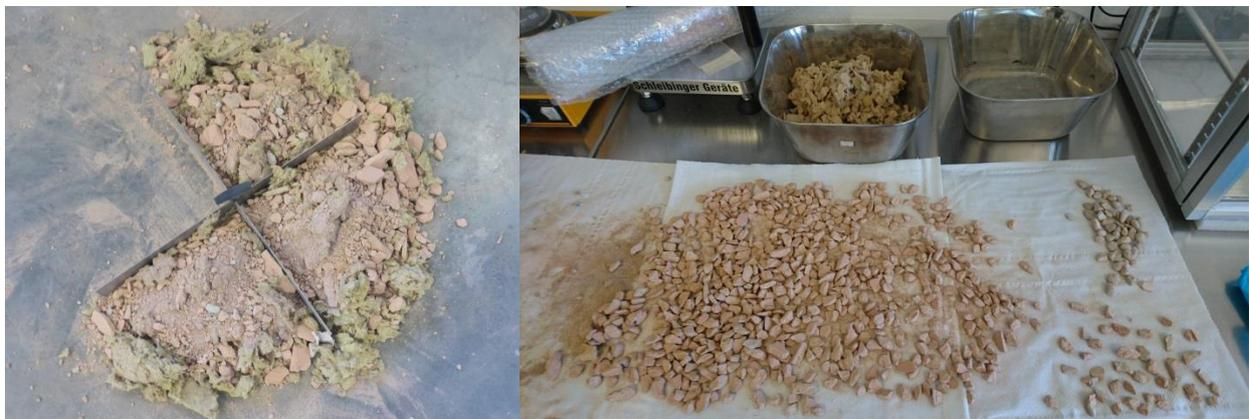
Bild 12: Probeteilung mittels Teilerkreuz (links) und händische Sortierung der Einzelpartikel je Fraktion (rechts)
