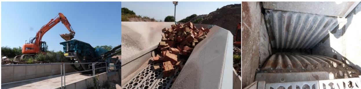
Bild 32: Backenbrecher (links) mit Materialzuführung (mittig) und Brechbacken (rechts)
