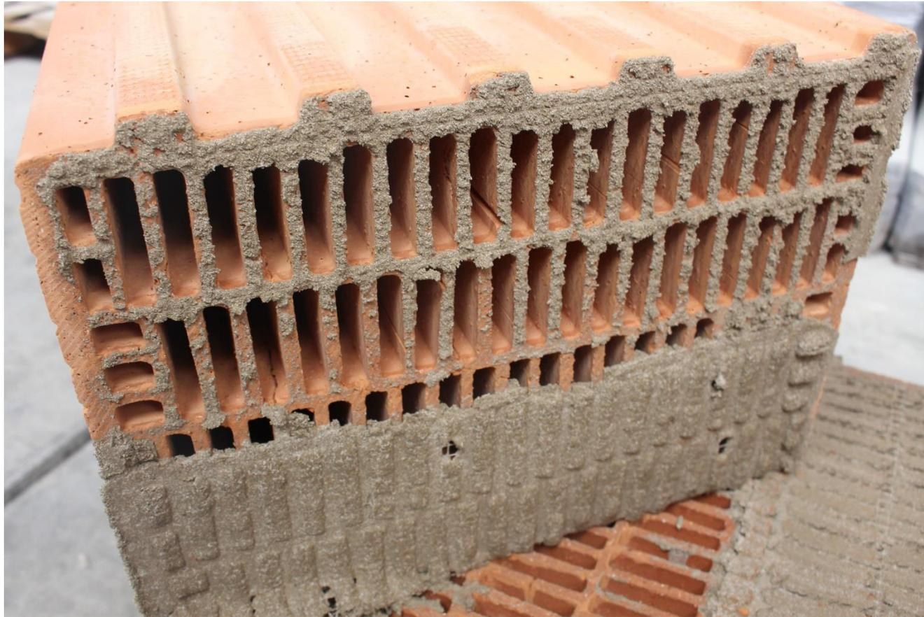
Mit der richtigen Wassermenge und dem richtigen Setzen des Steins in die Mörtelfuge sollte das Ergebnis so aussehen:
