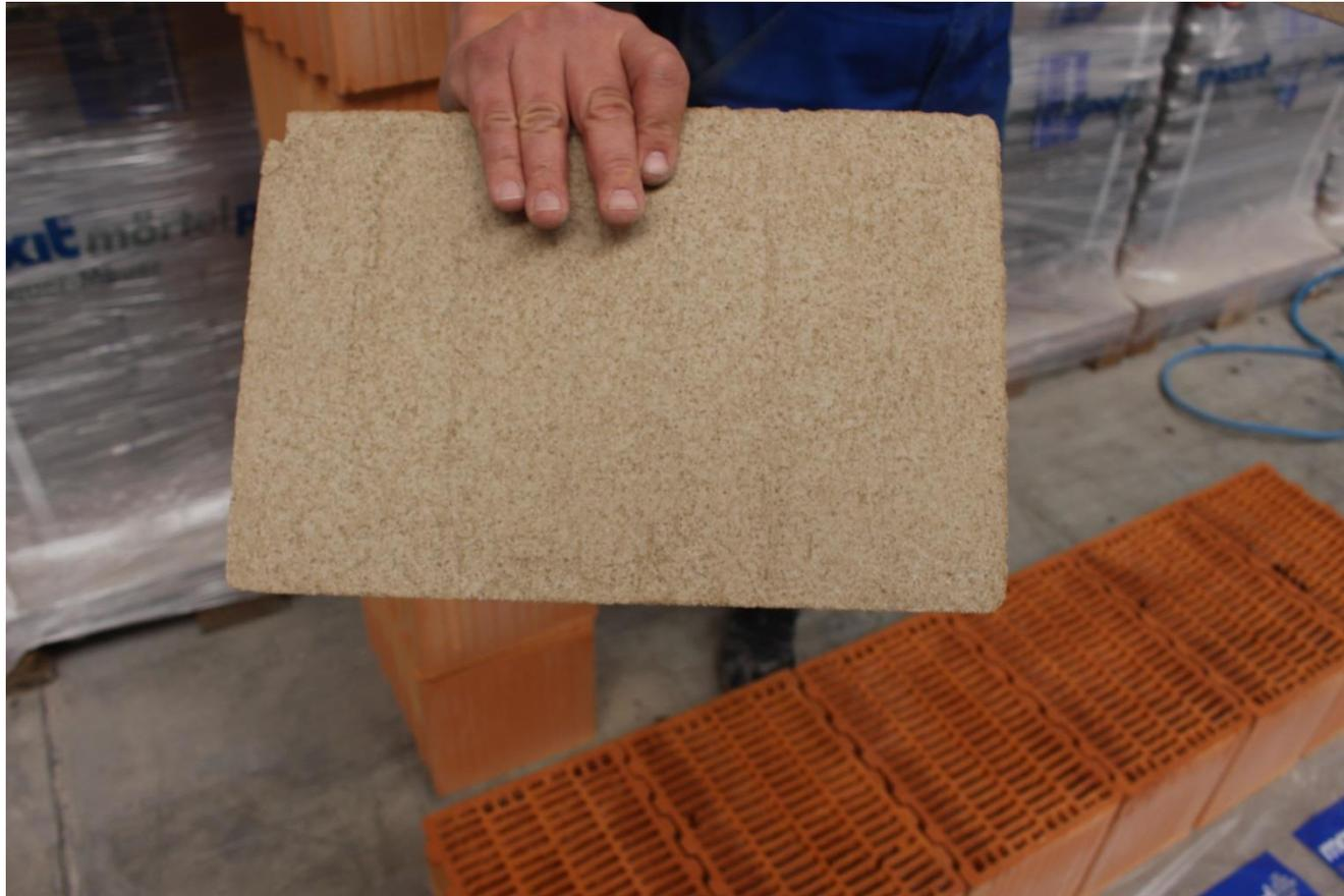
Das maxit Mörtelpad hat eine Ober- und eine Unterseite. Die flache Seite muss auf dem Mauerstein aufliegen.
