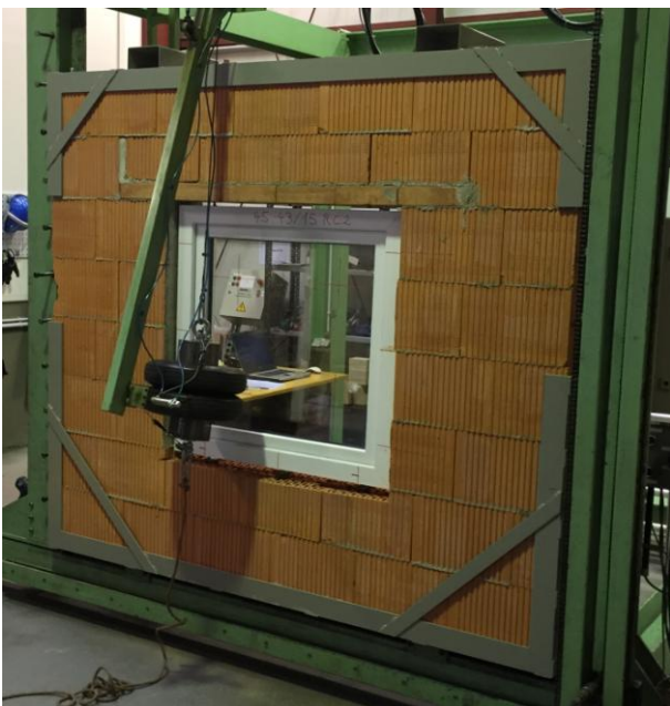
Bild 11: dynamische Belastung (DIN EN 1629)
