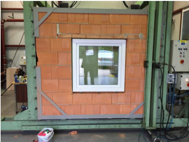
Bild 6: Ansicht des Prüfkörpers mit PHLzB6-0,9 im Prüfrahmen vor den Untersuchungen
