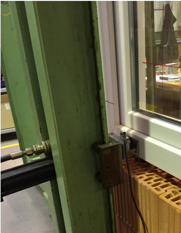
Bild 10: statische Belastung (DIN EN 1628)
