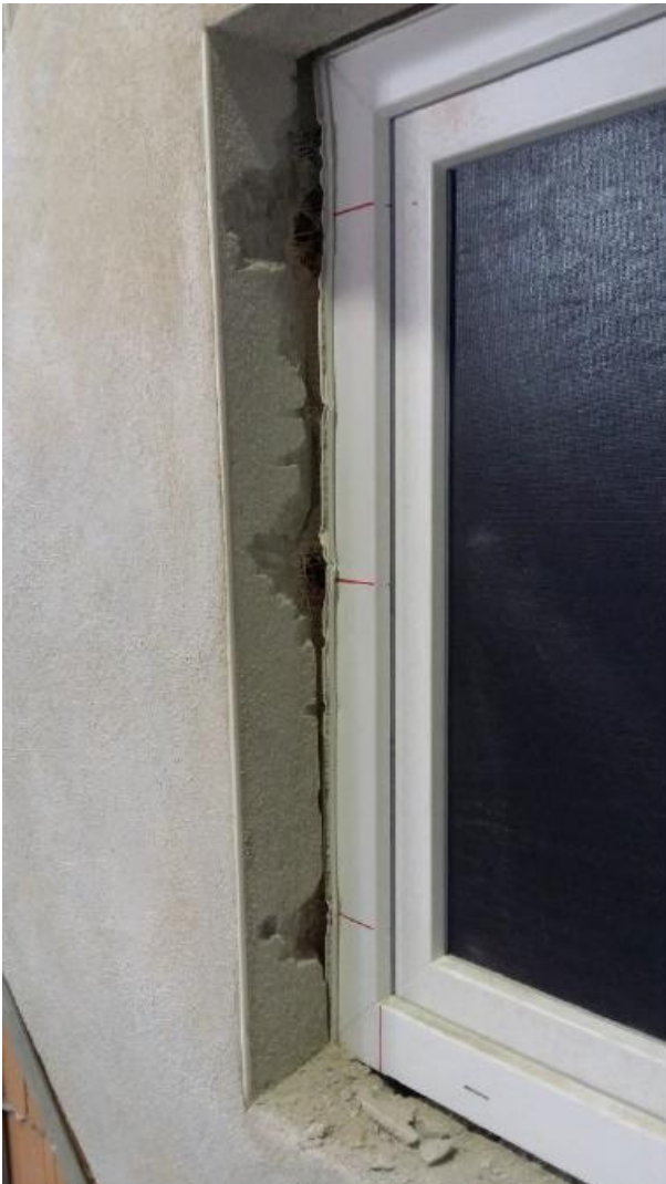
Bild 14: Laibung mit Armierungsputz nach Ende der normativen Versuchszeit für die Widerstandsklasse RC2 in PHLzB8 – 0,65 (Kleinlochung) Wanddicke 365 mm
