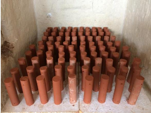
Abbildung 42: Anordnung der Probekörper während des Brandes
