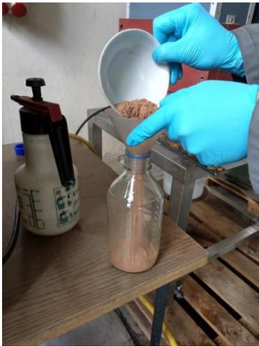
Abbildung 33: Nassmagnetscheidung; Einfüllen der trockenen Probe
