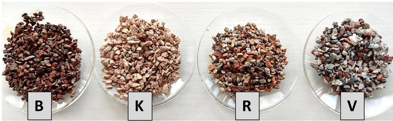
Abbildung 17: Material B (Pflasterziegel), K (Hintermauerziegel modern), R (ziegelreicher Bauschutt), V (ziegelreicher Mauerwerksbruch);
