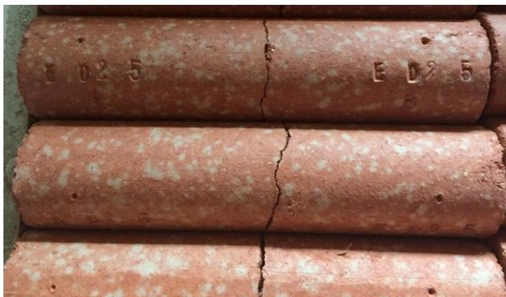
Nach der Prüfung der Wasseraufnahme kam es im Fall der Zugabe von 25% RC-Material D zu erheblichen Ausblühungen, wie sie in der nebenstehenden Abbildung 54 zu sehen sind. Diese stellen definitiv ein Ausschlusskriterium für die Zugabe von 25% RC- D zur Herstellung von Vormauerziegeln dar.
