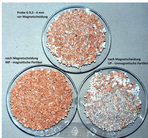
Abbildung 30: Probe G 0,5-4mm; vor und nach Magnetscheidung (Tabelle 26: Versuch 1)
