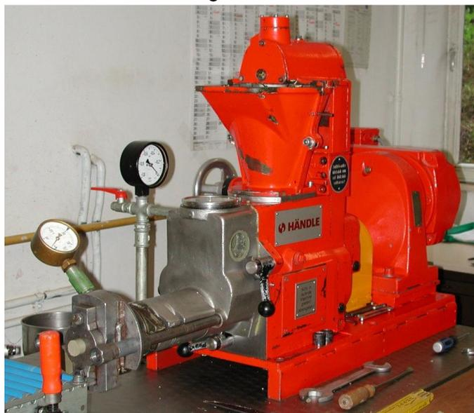
Abbildung 39: Vakuum-Laborschneckenpresse im Institut für Ziegelforschung
