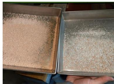
Abbildung 26: Ergebnis Magnet-scheidung (trocken)
