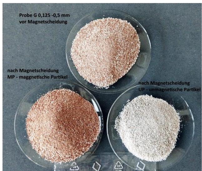
Abbildung 31: Probe G 0,125-0,5mm; vor und nach Magnetscheidung (Tabelle 26: Versuch 3)
