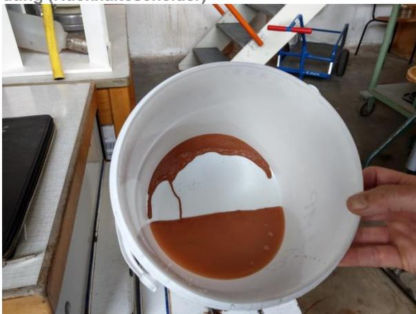
Abbildung 37: Magnetische Restprobe Nassmagnetscheidung
