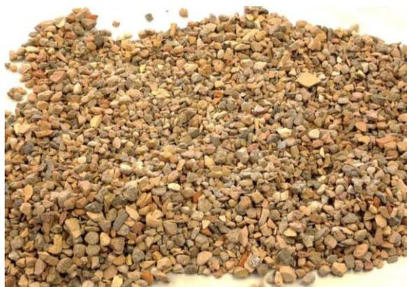
Abbildung 61: Mauerwerkbruch, Fraktion 8/16
