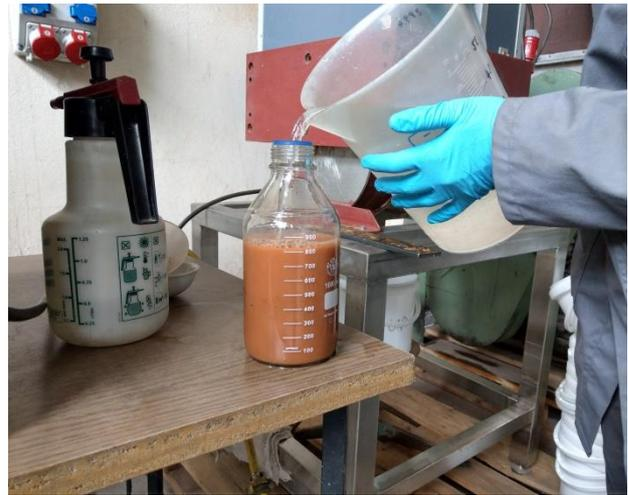
Abbildung 34: Nassmagnetscheidung; Herstellung einer Suspension
