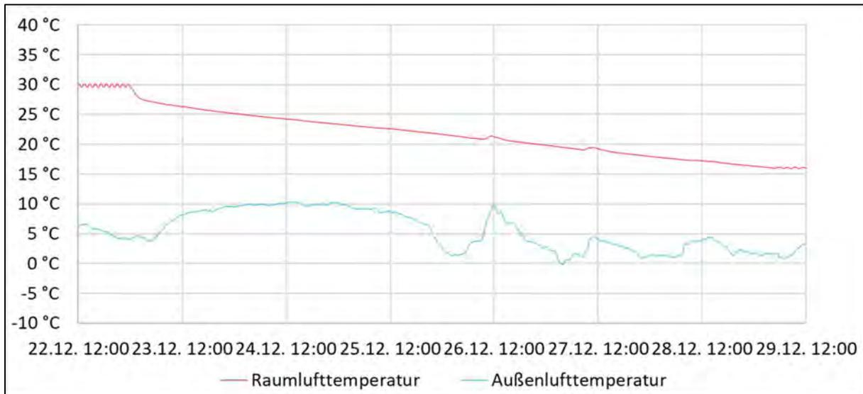
Abbildung 64: Künstliches Abkühlen – gemessene Raumluf- und Außenlufttemperatur für den Kalksandstein-Kubus
