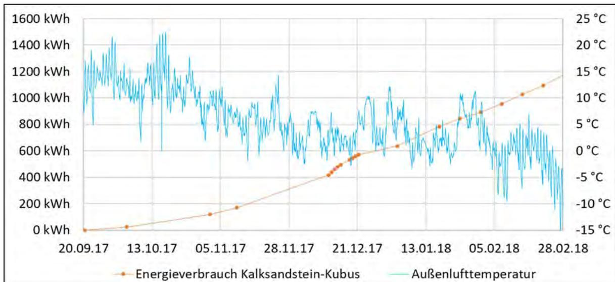
Abbildung 69: Heizperiodenverlauf – gemessener Energieverbrauch und Außenlufttemperatur für den Kalksandstein-Kubus
