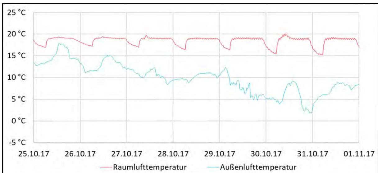
Abbildung 51: Nachtabenkung Heizung in Übergangszeit – gemessene Raumluft- und Außenlufttemperatur für den Porenbeton-Kubus
