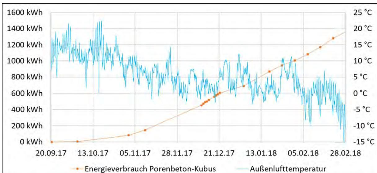
Abbildung 55: Heizperiodenverlauf – gemessener Energieverbrauch und Außenlufttemperatur für den Porenbeton-Kubus
