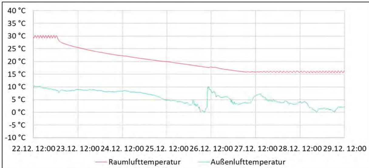
Abbildung 32: Künstliches Abkühlen – gemessene Raumluft- und Außenlufttemperatur für den Ziegel-Kubus
