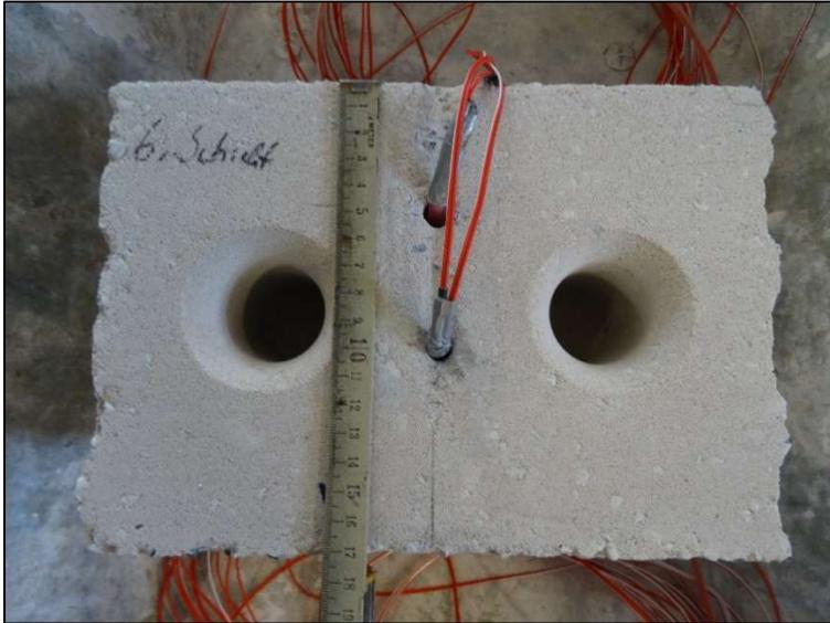
Abbildung 20: Präparierter Kalksandstein-Mauerstein
