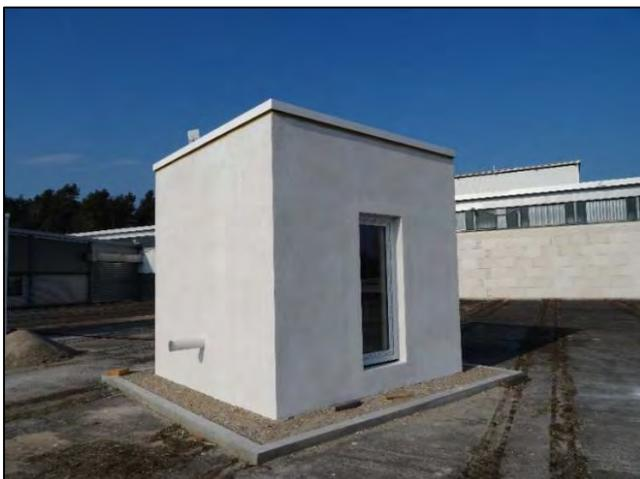
Abbildung 5: Errichteter Porenbeton-Kubus
