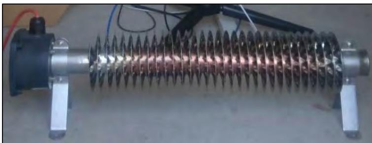
Abbildung 8: Installierter elektrischer Rippenrohrheizkörper
