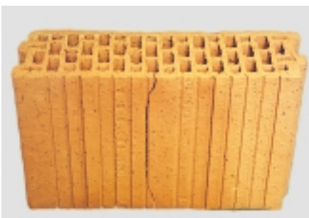
Bild 11 Ziegel mit Trocknungs- oder Brennrisse
